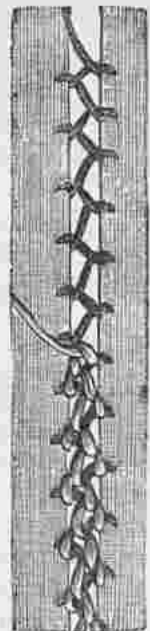
№ 16. Двойной перекрещивающийся шовъ для соединенія полосъ.
